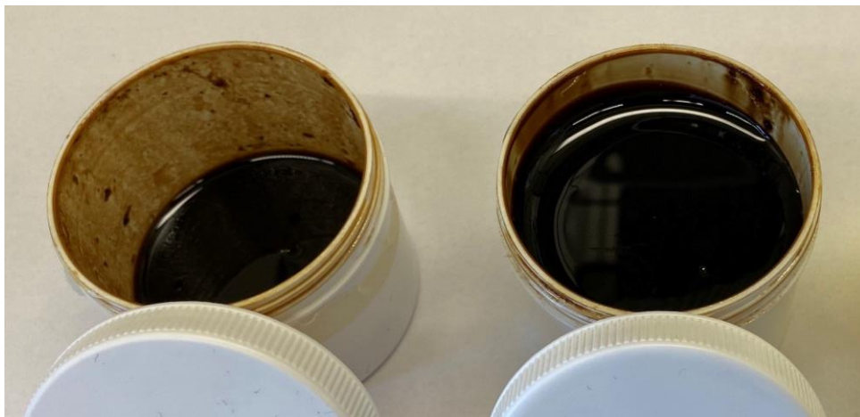
Foto: Kondensat aus der Kondensatfalle eines Reflowofens bei einem EMS-Dienstleister – 7,7 Gew.-% dieses bräunlichen, halbflüssigen Materials wurde per GC-MS-Analyse als Fotoinitiator 907 identifiziert
