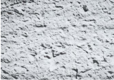
Abb. 4: Cu-Oberfläche nach Bimsmehlstrahlen 2500-fache Vergrößerung (© I.S. International Supplies s.r.l., Italien)
