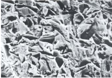
Abb. 6: Cu-Oberfläche nach Bimsmehlbürsten 2500-fache Vergrößerung (© I.S. International Supplies s.r.l., Italien)
