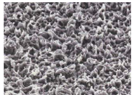
Abb. 12: Cu-Oberfläche nach MECetchBOND MEB
