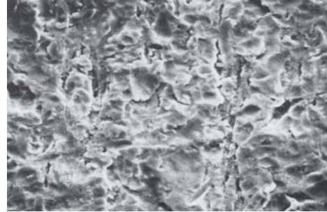
Abb. 5: Cu-Oberfläche nach Korundstrahlen 2500-fache Vergrößerung (© I.S. International Supplies s.r.l., Italien)
