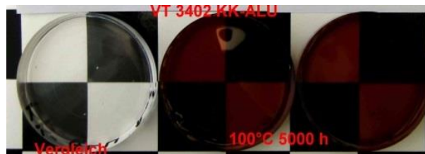
Abb. 3: Vergussmasse Wepuran VT 3402 KK-ALU links: Vergleich; rechts: extreme Vergilbung nach hoher Dauertemperaturbelastung oberhalb des angegebenen Temperatureinsatzbereichs
