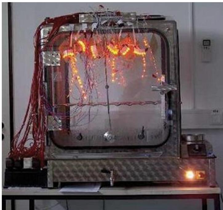
Die ELPECAST® Vergussmassen der Wepuran-Reihen VT 3402 KK-NV und VT 3402 OPAL im Prüfschrank „Schwitzwasser-Kabinett“ für Belastungsprüfungen. Foto: Peters
